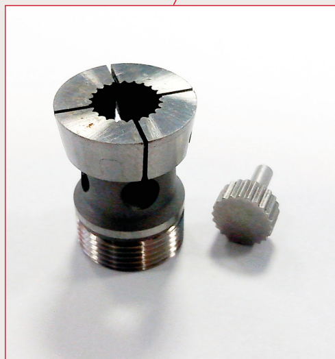
Pince de serrage pour les remontoirs de montres Collet for watch winders
