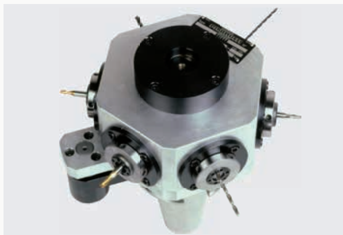
Tête angulaire 6 sorties ER16 - cône ISO50 I = 1 à 2 - 4000 tr/min en sortie Angle head 6 output Spindle collet ER16 - Shank ISO50 - ratio I = 1 to 2 - Max speed output 4000 rpm
