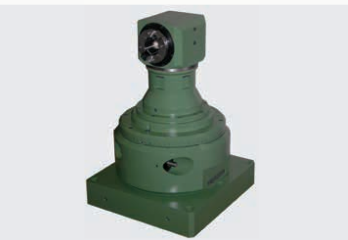
Tête angulaire avec multiplication intégrée 1 à 4 - ISO30 / ISO40 / ISO50 / 6000 - 12 000 t/min Angular heads with integrated multiplication 1:4 - ISO30 / ISO40 / ISO50 / 6000 - 12 000 rpm
